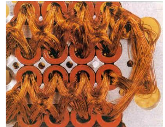
ROM tressé à la main: core rope memory
