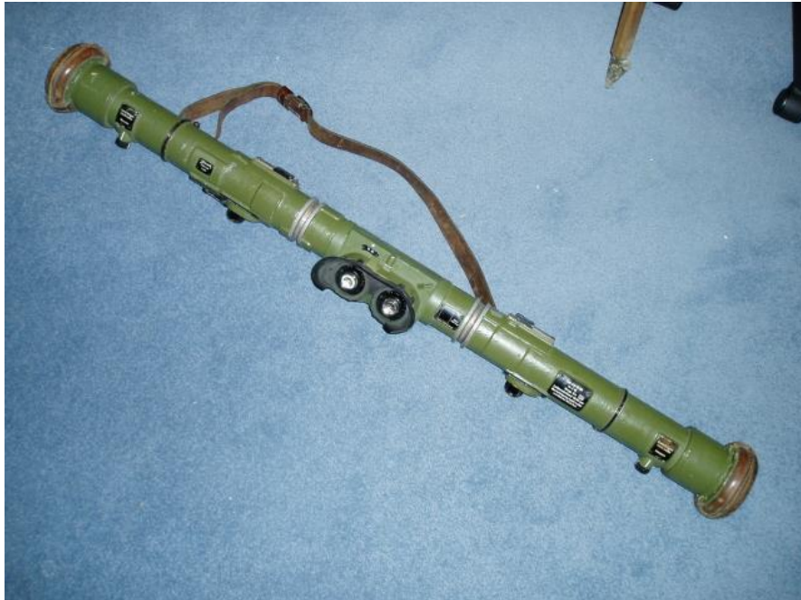
Télémètre Allemand Entfernungsmesser-1m-R-36 Tir anti-aérien Baseline b = 1 \text{ m}
