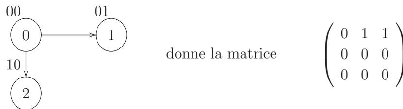
FIG. 5.3 – Graphe  $G$  et sa matrice de transitions.
